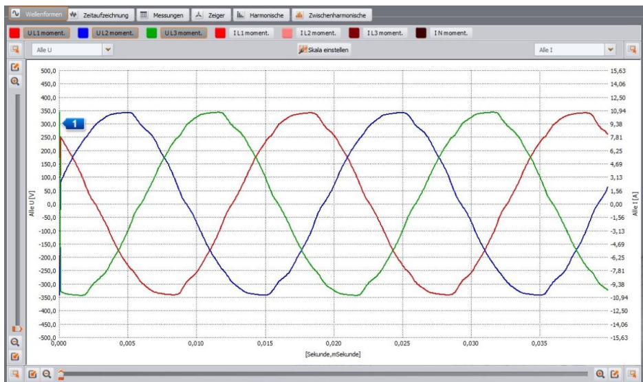
Abb. 47. Synchronisation von Wellenformen zwischen verschiedenen Analysatoren – sichtbare Synchronisationsmarkierung mit GPS-Zeit.
