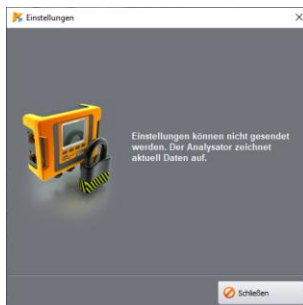
Abb. 18. Die Programmierung ist wegen der laufenden Aufzeichnung gesperrt.
